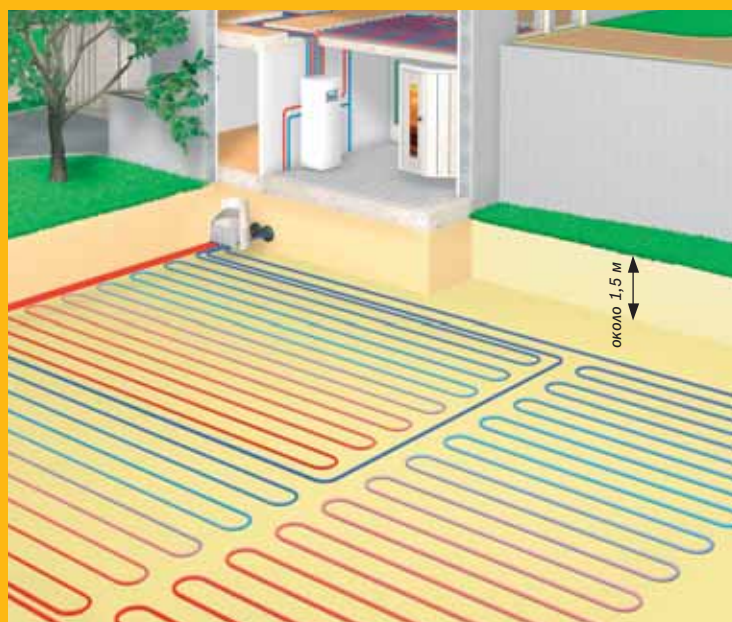
Грунтовой коллектор осваивает приповерхностное тепло
