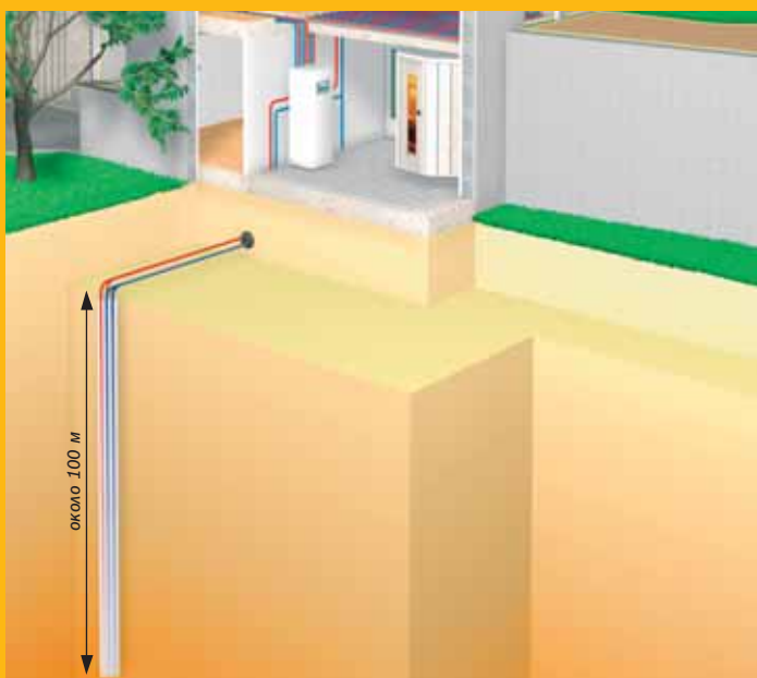
Грунтовой зонд осваивает глубинное геотермическое тепло
